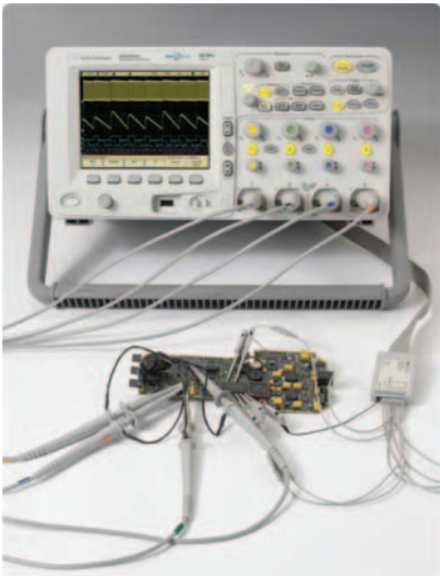
Осциллограф смешанных сигналов позволяет одновременно просматривать 4 аналоговых и 16 логических сигналов
